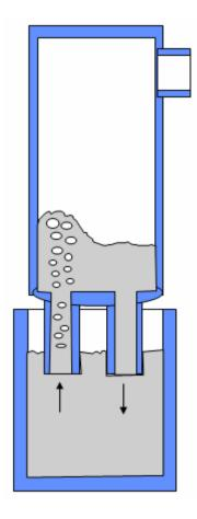
A Figura mostra um corte esquemático de um desgaseificador RH.
