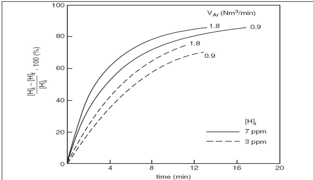
O gráfico acima, apresenta resultado da medida da cinética de remoção do Hidrogênio no aço, em panela submetida a vácuo e agitação com Argônio, através da reação  $2\text{H} = \text{H}_2$ . Note que o gráfico mostra a porcentagem de redução do teor de hidrogenio com o tempo. Por isto começa em 0% e tende a 100%, assintoticamente.
